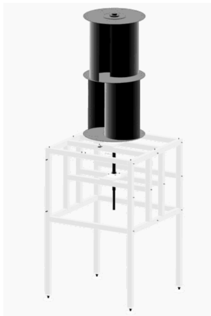
Abb. 12 Die gesamte Anlage in ProE gezeichnet
