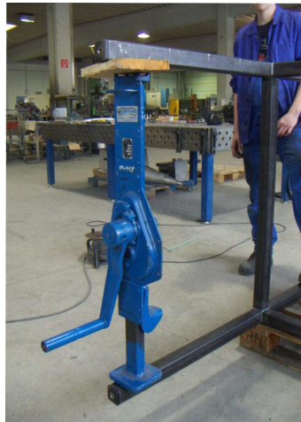
Abb. 30 Auseinanderbiegen der Stützen mit Hilfe der Winde
