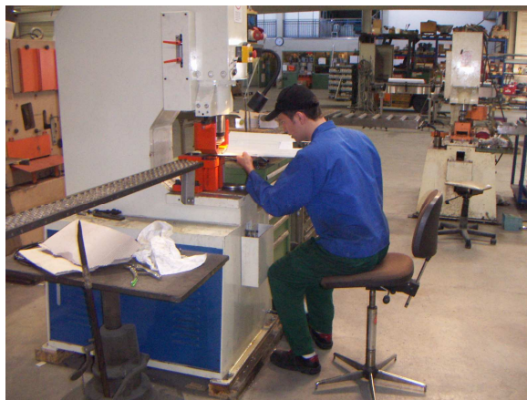
Abb. 32 Stanzen der Verkleidungsbleche
