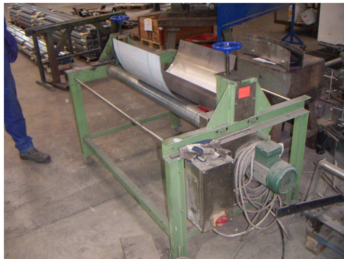
Abb. 23 Biegen der Rotorbleche an der automatischen Walze
