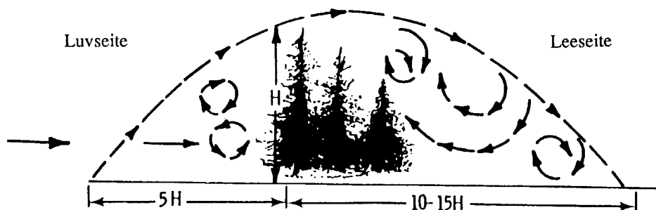
Abb. 54: Störung der Windströmung durch eine Baumgruppe [15, S.102]
