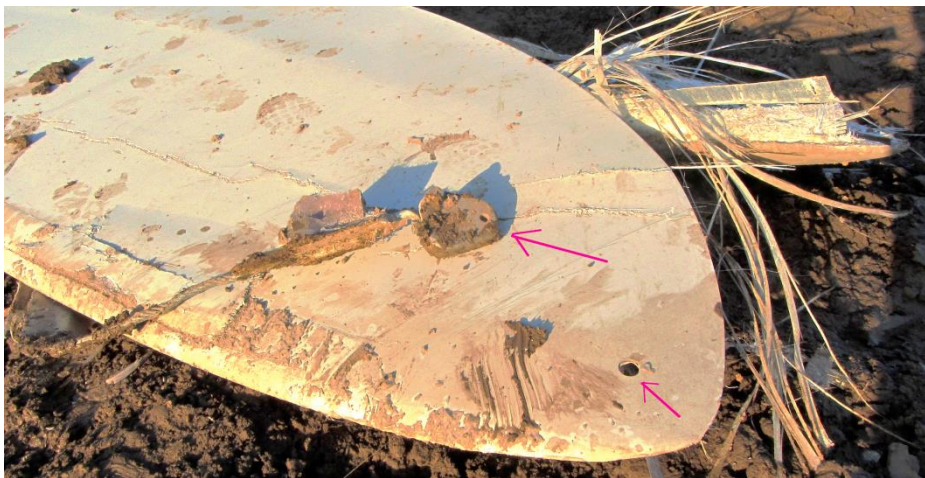
Abb. 6 Blitzschutzelemente vom Blatt einer Groß-WEA 1,5 MW
