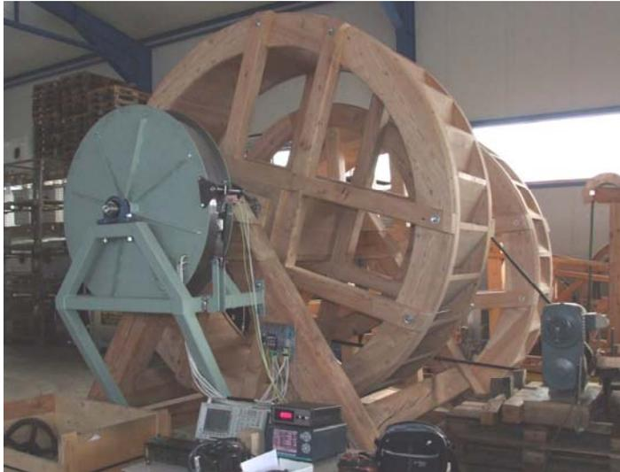
Bild 7: Generator mit Wasserrad am Leistungsprüfstand
