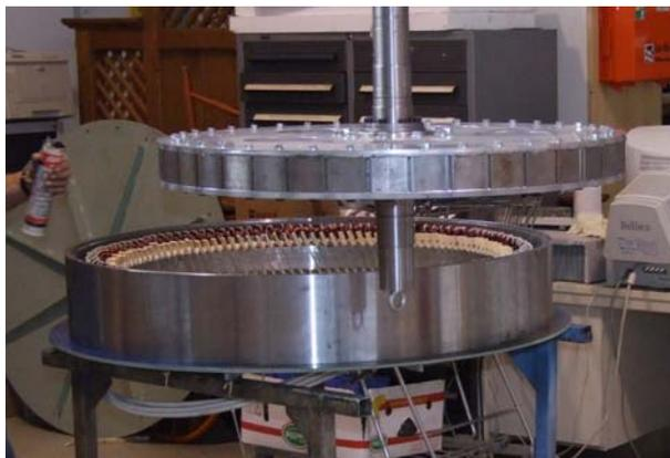
Bild 5: Montage des Rotors
