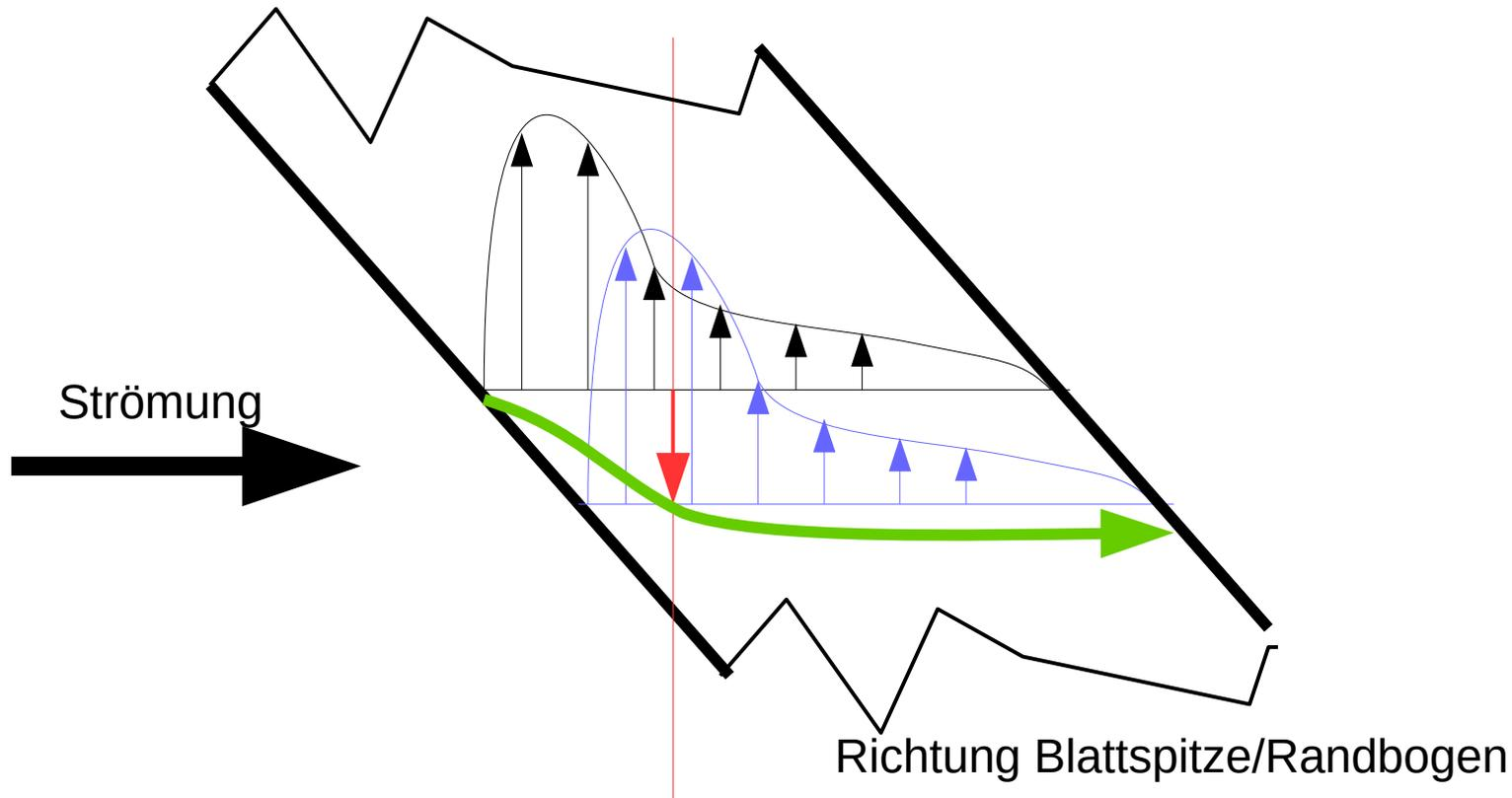
Schwarz/blau: Druckverteilung (nach oben geklappt) mit Unterdruck Saugseite an 2 versch. Pos..
