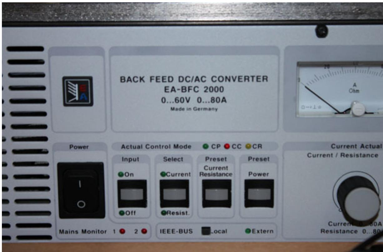
Dieses Gerät kann den Generator mit einem stufenlos einstellbaren Strom belasten. Damit die Energie nicht verheizt werden muss, speist das Gerät, ähnlich einem Wechselrichter, direkt ins Netz zurück.
