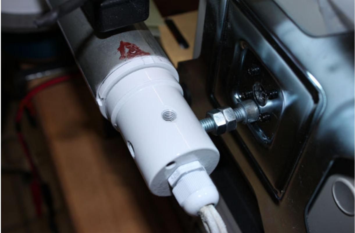
Am Festschraubpunkt des Windrades wurde eine Schraube eingedreht die mit einem Abstand von  $\frac{1}{3}$  m aus der Drehachse auf die Wägezelle der „Mettler Toledo Präzisionswaage drückt. Durch Umrechnung kann nun das erzeugte Drehmoment direkt ermittelt werden.
