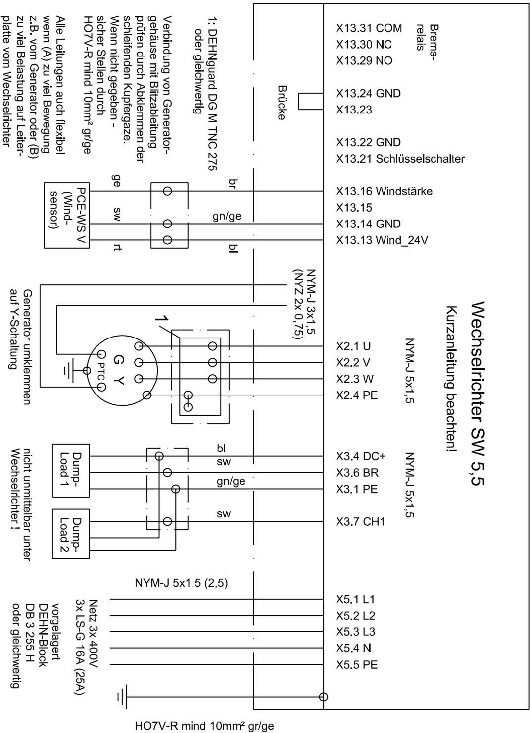
Verbindung von Generator-gehäuse mit Blitzableitung prüfen durch Abklemmen der schleifenden Kupfergaze. Wenn nicht gegeben - sicher Stellen durch HO7V-R mind 10mm<sup>2</sup> gr/ge
