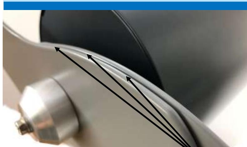
Achten Sie unbedingt darauf, dass **die beiden Rotorblätter exakt übereinander liegen!** Abweichungen bedeuten eine Unwucht und führen zu lauten Geräuschen Gondelschütteln und Materialschäden bis zum Rotorabriss! Nur das Aufstecken anhand der Nut ist nicht ausreichend!
