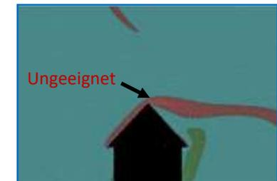
**Platzierung auf dem First:** Halten Sie sich für die Standortwahl stets möglichst in der Mitte des Dachfirsts. Für eine einzelne Turbine wählen Sie die Mitte des Daches. Für zwei Turbinen wählen Sie also zum Beispiel 2,5m links und 2,5m rechts der Mitte.
