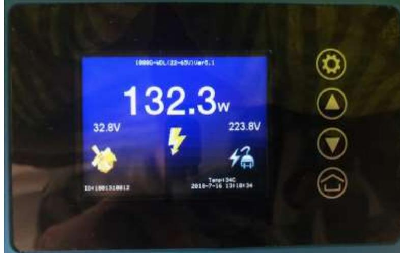
Betriebsdatenanzeige des SkyWind Wechselrichters
