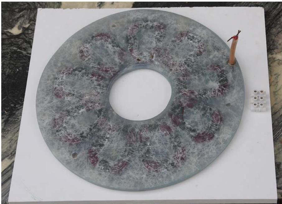
Im nächsten Schritt werden die Löcher für die Stator-Haltebolzen gesetzt.
