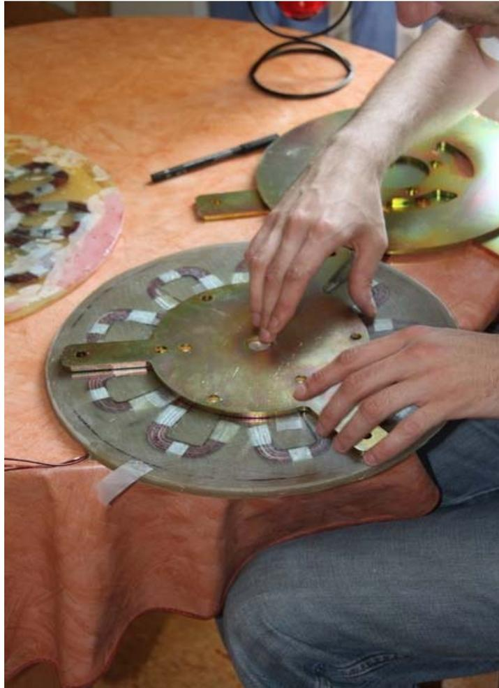
Anschließend mit Bleistift markieren und 9er Löcher für die 8er Gewindestangen bohren.
