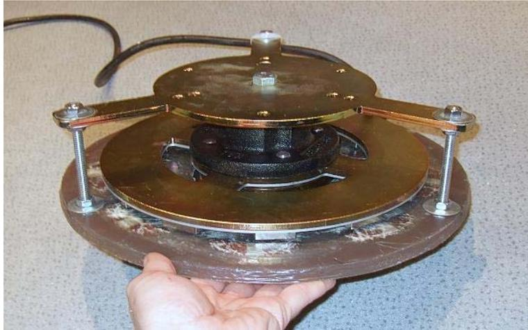
Nach dem Montieren der Rotorblätter kann die Repellernabe mit auf die Lagerbolzen aufgeschraubt und gekontert werden.
