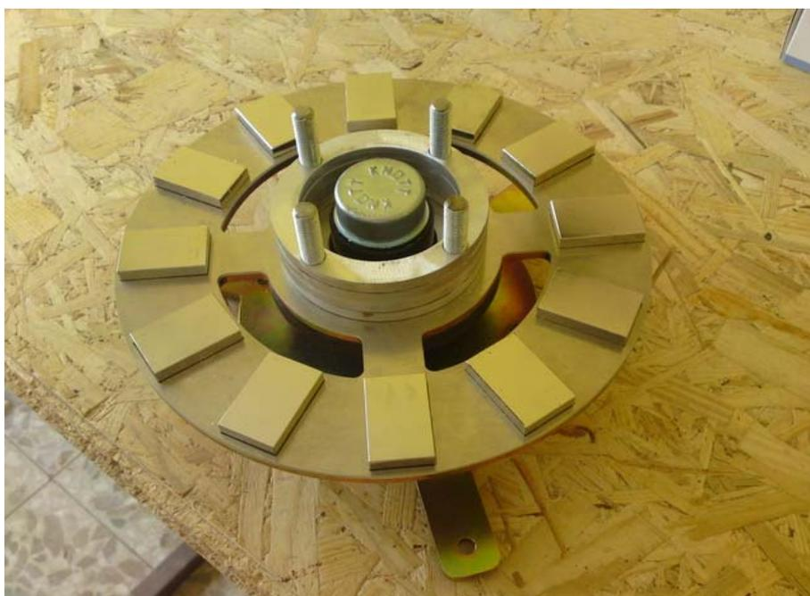
Nun werden die **Edelstahl**gewindestangen zugeschnitten und an den Tragarmen des Statorhalters mit den mitgelieferten Muttern und Unterlegscheiben verschraubt und die unteren Muttern und U-Scheiben in Position gebracht welche den Stator halten sollen.
