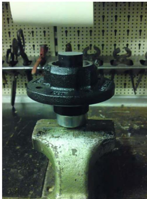
Anschließend wird der Mittelpunkt bestimmt und dort eine 10er Bohrung von etwa drei cm Tiefe angebracht. Am besten ist es, mit einem 6er Bohrer vorzubohren und dann erst auf 10er zu gehen. Es empfiehlt sich viel Schneideöl zu verwenden damit die Bohrer nicht gleich ausglühen.
