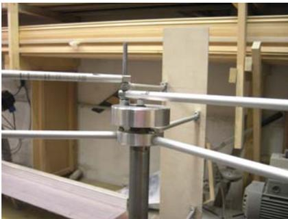
Fertig montierte Flügel und Excenter mit Speichen
