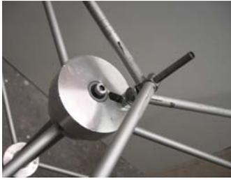
Gut zu erkennen, das Langloch zum verschieben des Bolzen
