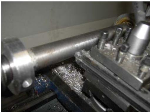
die fertige Hauptwelle wird überdreht
