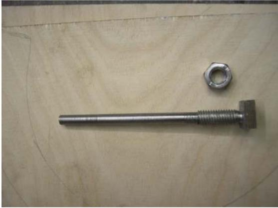
fertiger Bolzen mit Nutenplatte und Befestigungsmutter
